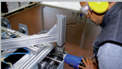
Bild 1 Ansetzen des RIVTAC® Portable
