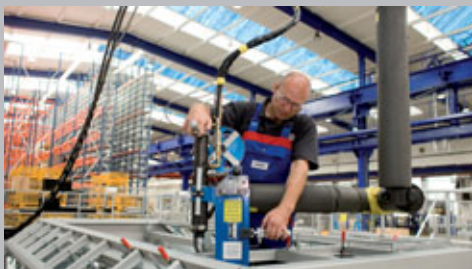
Bild 3 RIVSET® Gerät mit gyroskopischer Aufhängung
