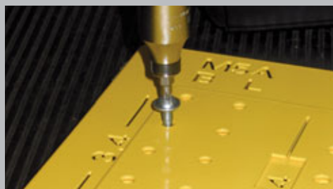
Bild 3 Schraubprüfungen am SCHATZ Prüfstand
