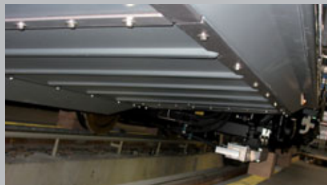
Bild 3 Im Unterflur montierte Aluminiumleisten
