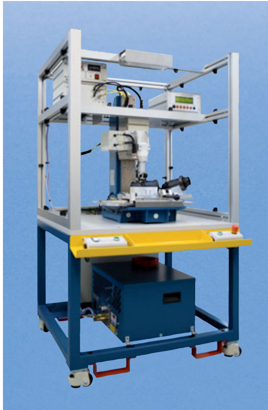
EWS-Warmeinbaumaschine zum Einbetten von Inserts in PKW-Motorraumteile
