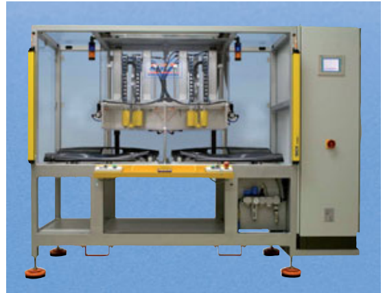
Warmeinbaumaschine in Sonderbauweise zum gleichzeitigen Einbetten von 6 Inserts in zwei PKW-Türinnenverkleidungen
