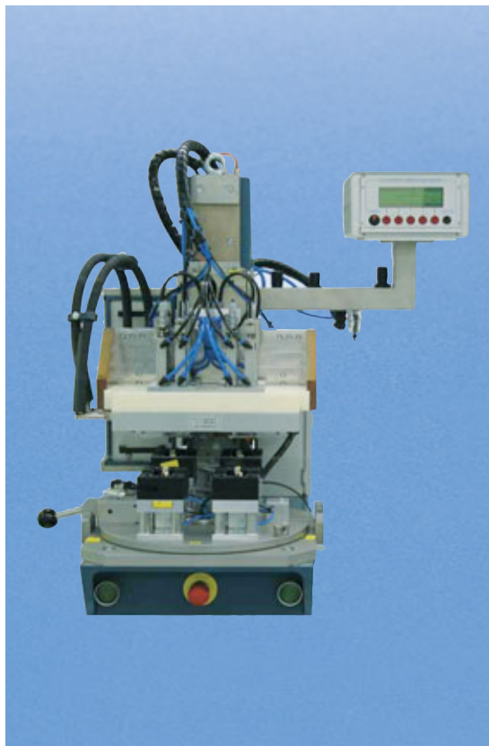
EWS-Warmeinbaumaschine zum Einbetten von acht Inserts M 1,6 in zwei Handyhalbschalen
