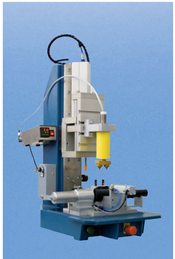
Warmeinbaumaschine KVT Basic 2500 zum gleichzeitigen Warm-Einbetten von zwei Inserts in ein PKW-Ladeluftrohr
